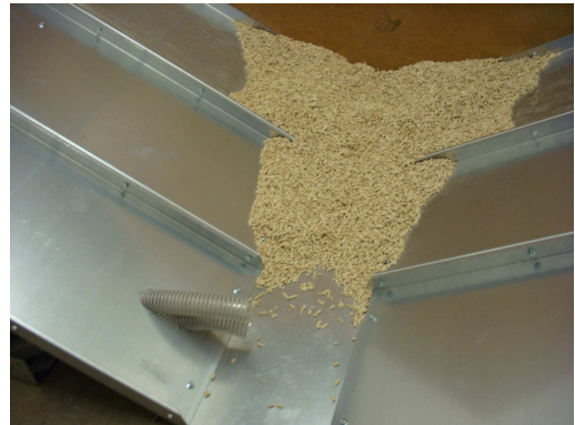
Bild 2 Durchführung für Saugschläuche jeweils 3 x pro Schrägboden
